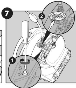
Desmonte la tapa del impulsor y limpie alrededor del compartimiento del impulsor, después reensamble.
